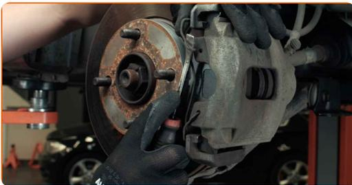
11 Entfernen Sie den Bremssattel.
