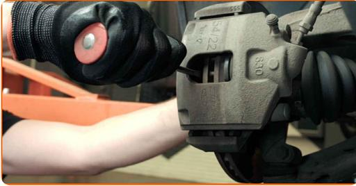
8 Entfernen Sie die Staubschutzkappen der Bremssattel-Führungsstifte. Benutzen Sie ein Brecheisen.
