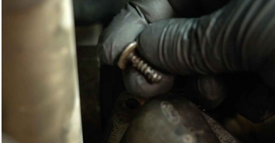
14 Entfernen Sie den Thermostatgehäusedeckel.
