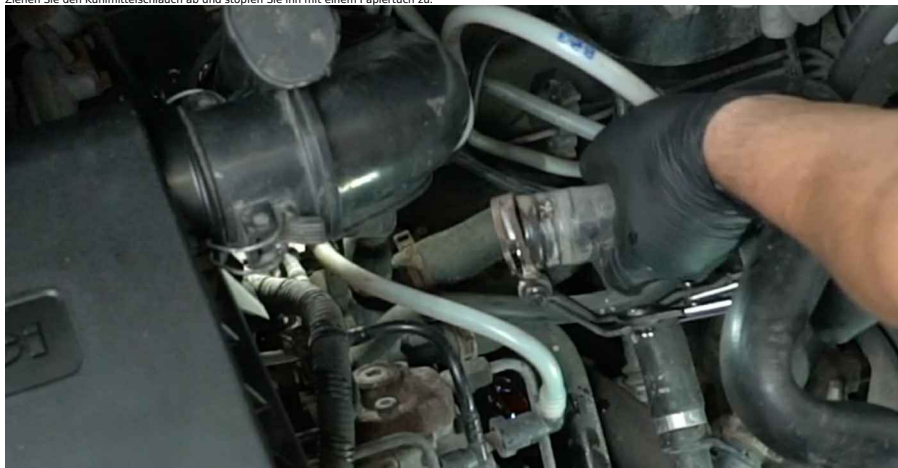
11 Reinigen Sie die Befestigungsschrauben des Thermostatgehäusedeckels. Benutzen Sie eine Drahtbürste. Verwenden Sie ein Allzweck-Reinigungsspray.
