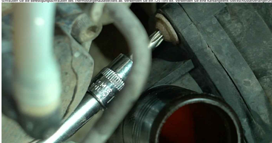
13 Entfernen Sie die Befestigungsschrauben.
