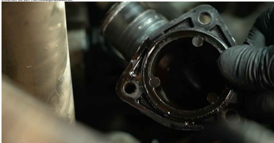
15 Entfernen Sie das Thermostat.
