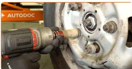
**27** Senken Sie das Auto ab und ziehen Sie die Radschrauben über Kreuz fest. Verwenden Sie eine Schlagnuss für Felgen mit einem Durchmesser von 21 mm. Verwenden Sie einen Drehmomentschlüssel. Anzugsdrehmoment: 200 N·m.
