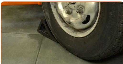
**4** Lockern Sie die Radmuttern. Verwenden Sie eine Schlagnuss für Felgen mit einem Durchmesser von 21 mm. Verwenden Sie einen Drehstift.
