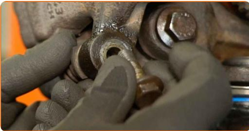
12 Entfernen Sie den Bremssattel.
