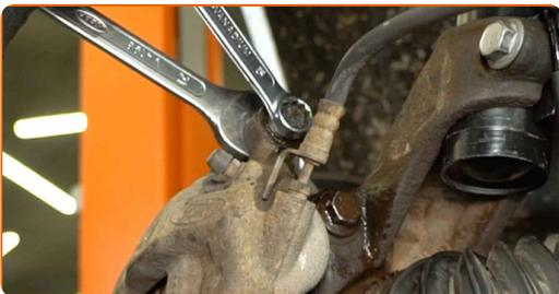
11 Entfernen Sie die Befestigungsschrauben.
