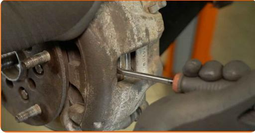
9 Reinigen Sie die Befestigungsschrauben des Bremssattels. Benutzen Sie eine Drahtbürste. Verwenden Sie WD-40-Spray.
