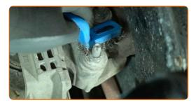
Schrauben Sie die unteren Befestigungsschrauben des Motorlagers ab. Verwenden Sie eine Stecknuss mit einem Durchmesser von 13 mm. Verwenden Sie einen Ratschenschlüssel.
