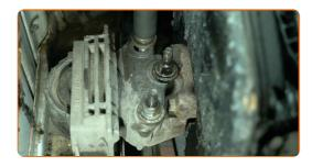
8 Entfernen Sie das Motorlager.
