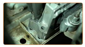
Ziehen Sie die oberen Befestigungsmuttern des Motorlagers fest. Verwenden Sie eine Stecknuss mit einem Durchmesser von 18 mm. Verwenden Sie einen Drehmomentschlüssel. Anzugsdrehmoment: 115 N·m.
