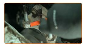
Setzen Sie ein neues Motorlager ein.
