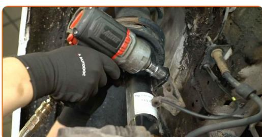
**22** Entfernen Sie die ABS-Sensorkabelhalterung vom Federbein.
