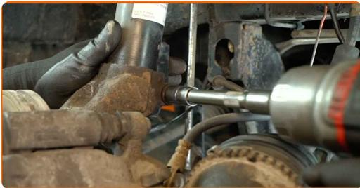
**41** Entfernen Sie die Befestigungsschraube.
