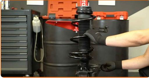
**64** Nehmen Sie die Federbeinbaugruppe aus dem stationären Federspanner.
