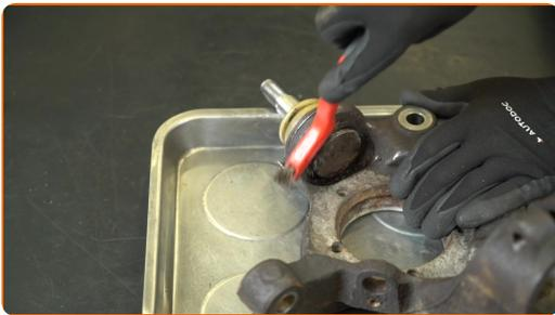
45 Entfernen Sie den Sicherungsring. Verwenden Sie eine Sicherungsringzange.
