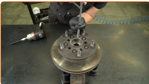
43 Entfernen Sie die Radnabe zusammen mit der Bremsscheibe.
