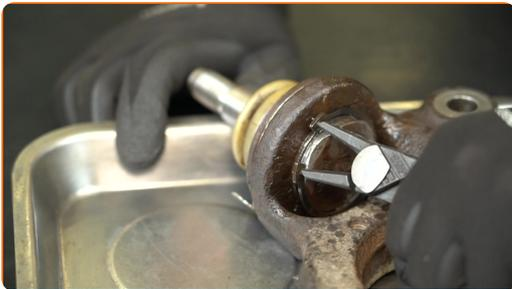
46 Drücken Sie das Kugelgelenk aus dem Achsschenkel. Verwenden Sie einen Kugelgelenkausdrücker-Satz.
