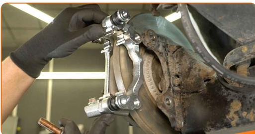
23 Setzen Sie die Befestigungsschrauben ein und schrauben Sie sie an.
