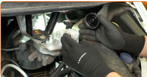
38 Schrauben Sie den Deckel des Bremsflüssigkeitsbehälters fest.
