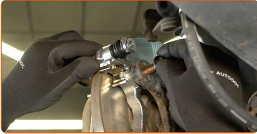
24 Ziehen Sie die Befestigungsschrauben des Bremssattelträgers fest. Verwenden Sie eine Stecknuss mit einem Durchmesser von 15 mm. Verwenden Sie einen Drehmomentschlüssel. Anzugsdrehmoment: 115 N·m.
