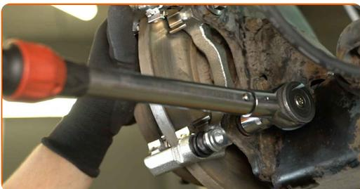
25 Montieren Sie die Bremsbeläge.
