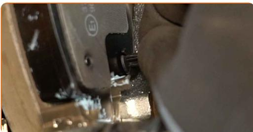
27 Montieren Sie den Bremssattel.
