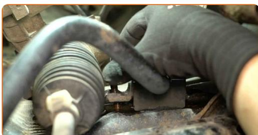
**14** Entfernen Sie die Halterung des Stabilisatorlagers.
