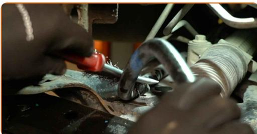
**18** Bringen Sie ein neues Stabilisatorlager auf einer Seite der Achse an.
