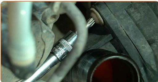
**13** Entfernen Sie die Befestigungsschrauben.
