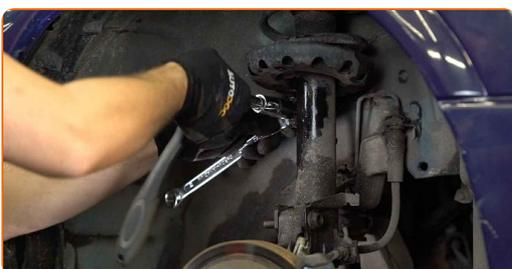
**8** Reinigen Sie die Befestigungen der Koppelstange. Benutzen Sie eine Drahtbürste. Benutzen Sie WD-40-Spray.
