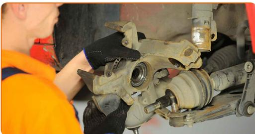
**31** Befestigen Sie das Dämpferbein auf dem Achsschenkel. Benutzen Sie einen Hammer.
