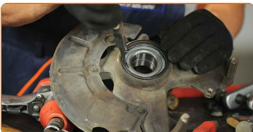
**28** Drücken Sie die Radnabe in den Lagerinnenring. Verwenden Sie einen Druckstücksatz mit Ein-/Auspresswerkzeug.
