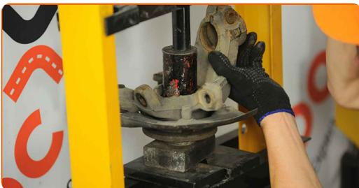
**30** Installieren Sie den Achsschenkel mit einer Nabe.
