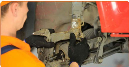
**32** Ziehen Sie die untere Befestigung des Stoßdämpfers an. Verwenden Sie Ring-Gabelschlüssel Nr. 18. Verwenden Sie Stecknuss Nr. 18. Verwenden Sie einen Drehmomentschlüssel. Ziehen Sie ihn mit 60 Nm Drehmoment fest.+90°
