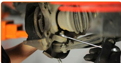
**18** Ziehen Sie den unteren Arm vom Achsschenkel ab. Benutzen Sie einen Hammer. Benutzen Sie ein Brecheisen.
