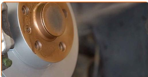
**44** Die Bremsscheibenoberfläche reinigen. Benutzen Sie einen Bremsenreiniger.
