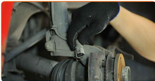
**16** Reinigen Sie das Verbindungselement, welches das Kugelgelenk mit dem Achsschenkel verbindet. Benutzen Sie eine Drahtbürste. Benutzen Sie WD-40-Spray.
