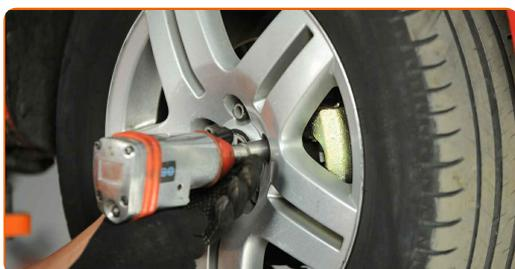
**47** Senken Sie das Auto und ziehen Sie die Radschrauben über Kreuz an. Verwenden Sie einen Drehmomentschlüssel. Ziehen Sie ihn mit 120 Nm Drehmoment fest.
