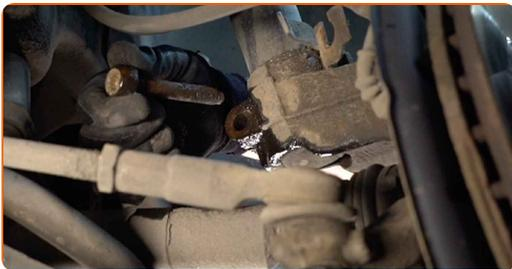
**20** Reinigen Sie alle Verbindungen des Querlenkers. Benutzen Sie eine Drahtbürste. Benutzen Sie WD-40-Spray.
