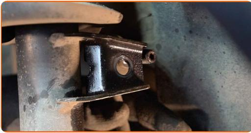
**18** Schrauben Sie das untere Befestigungselement ab, dass das Federbein mit dem Achsschenkel verbindet. Verwenden Sie Stecknuss Nr. 18. Benutzen Sie den XZN #12. Verwenden Sie einen Ratschenschlüssel. Verwenden Sie ein Windeisen.
