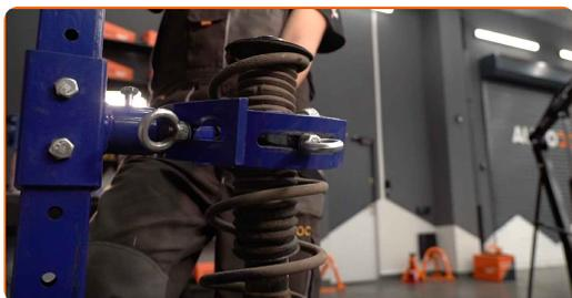
**38** Die Staubkappe des Stoßdämpfers und den Anschlagpuffer entfernen.
