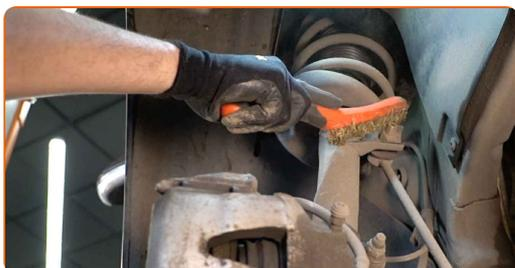
**15** Die Befestigungselemente, die das Federbein mit dem Achsschenkel verbinden, reinigen. Benutzen Sie eine Drahtbürste. Benutzen Sie WD-40-Spray.
