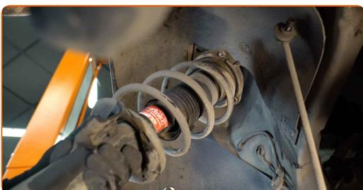
**32** Stellen Sie das Dämpferbein auf das Federspannwerkzeug.
