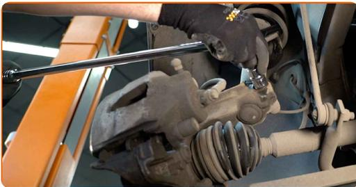
**19** Entfernen Sie die Befestigungsschraube.
