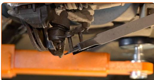
**23** Lösen Sie das Befestigungselement, welches die Antriebswelle mit der Radnabe verbindet. Verwenden Sie Stecknuss Nr. 27.
