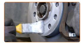
Die Bremsscheibenoberfläche reinigen. Benutzen Sie einen Bremsenreiniger.
