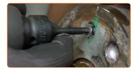
19 Entfernen Sie die Befestigungsschraube.
