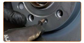
Ziehen Sie die Befestigung der Bremsscheibe fest. Verwenden Sie den Torx T30. Verwenden Sie einen Drehmomentschlüssel. Ziehen Sie ihn mit 8 Nm Drehmoment fest.
