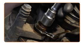
Entfernen Sie die Befestigungsschrauben.
