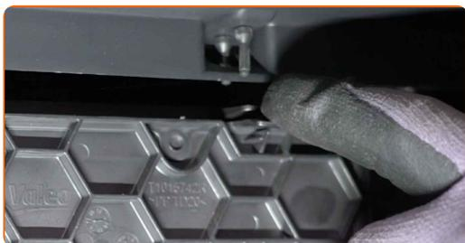
**5** Entfernen Sie den Gehäusedeckel des Innenraumfilters.
