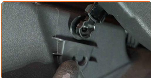
**4** Lösen Sie die Befestigungsclips der Innenraumfilterabdeckung.
