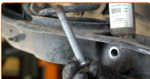
**20** Den Stoßdämpfer entfernen.
