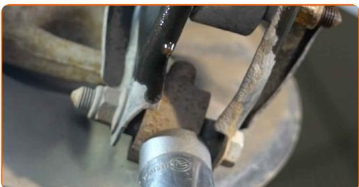
**8** Schrauben Sie den unteren Befestiger des Stoßdämpfers ab. Verwenden Sie Ring-Gabelschlüssel Nr. 18. Verwenden Sie Stecknuss Nr. 18. Verwenden Sie einen Ratschenschlüssel.
