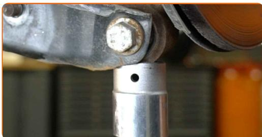
**19** Entfernen Sie die Befestigungsschraube.
