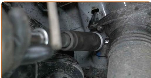
**17** Entfernen Sie die Befestigungsschrauben.
