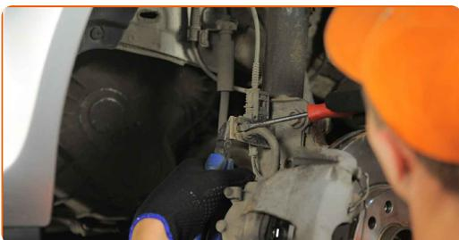
**7** Trennen Sie den Stecker des ABS-Sensors. Verwenden Sie einen flachen Schraubendreher.
