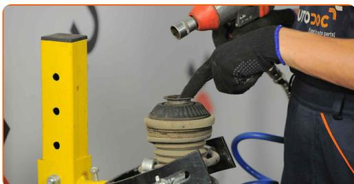
**24** Entfernen Sie die Stangenmutter des Federkolben. Verwenden Sie Stecknuss Nr. 21. Verwenden Sie einen Ratschenschlüssel.
