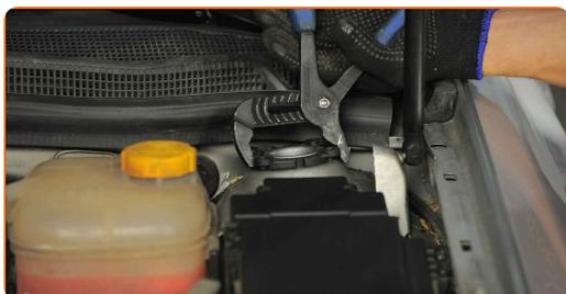
**34** Setzen Sie die Federbeinlagerkappe auf.
