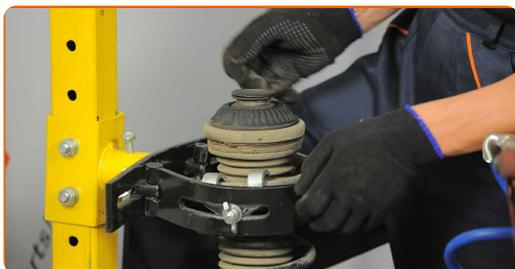
**22** Entfernen Sie die Federbeinlagerkappe. Verwenden Sie einen flachen Schraubendreher.
