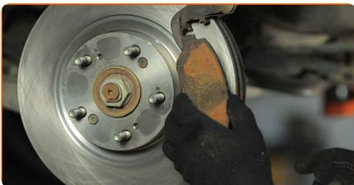
**Austausch: Bremsbeläge – HONDA Accord VII Limousine (CL, CN). Tipp von AUTODOC:**
