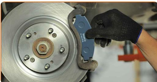
**Austausch: Bremsbeläge – HONDA Accord VII Limousine (CL, CN). Tipp:**
