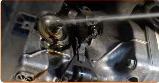
**12** Schrauben Sie den neuen Filter in seinen Platz. Verwenden Sie Steckschlüssel 65/14-F. Halten Sie das empfohlene Anzugsdrehmoment ein.
