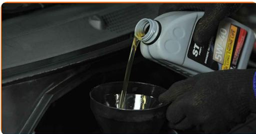
Austausch: Motoröl und Ölfilter – HONDA Accord VII Limousine (CL, CN). Tipp:
