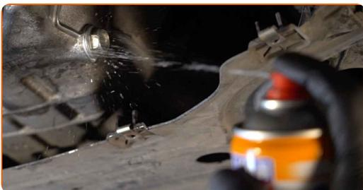
9 Schrauben Sie den Ölfilter ab. Verwenden Sie Steckschlüssel 65/14-F. Verwenden Sie einen Ratschenschlüssel.
