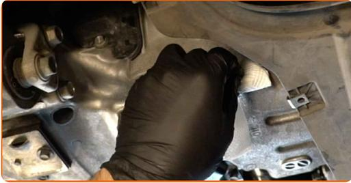
7 Schrauben Sie die neue Ablassschraube ein und ziehen Sie sie fest. Verwenden Sie Stecknuss Nr. 17. Verwenden Sie einen Drehmomentschlüssel. Ziehen Sie ihn mit 39 Nm Drehmoment fest.
