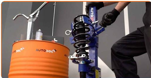
**35** Behandeln Sie die Befestigungselemente des Federbeinstützlagers. Benutzen Sie WD-40-Spray.
