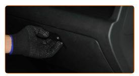
Lösen Sie das Sperrkabel (Kabelband) vom Handschuhfachdeckel. Verwenden Sie einen flachen Schraubendreher.
