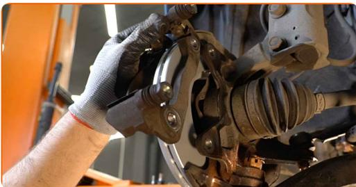
**23** Befestigen Sie die Bremssattelhalterung. Verwenden Sie Stecknuss Nr. 19. Verwenden Sie einen Drehmomentschlüssel. Ziehen Sie ihn mit 108 Nm Drehmoment fest.
