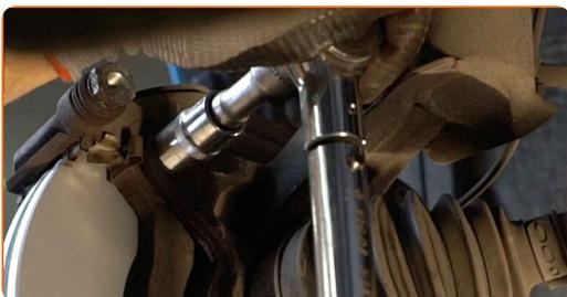
**24** Behandeln Sie den Bremssattel-Kolben. Benutzen Sie einen Bremsenreiniger.
