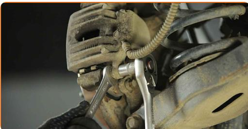
**9** Entfernen Sie die Führungsstifte aus dem alten Bremssattel.
