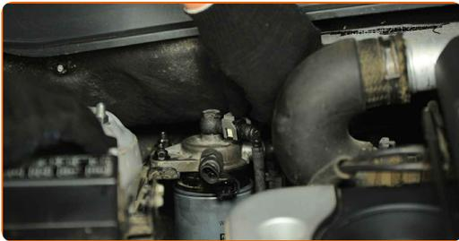
19 Bringen Sie den Anschluss des Kraftstoffdrucksensors an.
