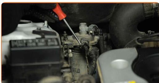
**4** Reinigen Sie die Befestigungen der Kraftstoff-Zuleitungen. Verwenden Sie Allzweckreinigungsspray.
