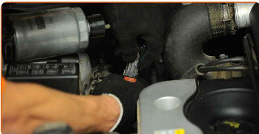
16 Schrauben Sie die Befestigungsbolzen der Treibstofffilterhalterung an. Verwenden Sie Ring-Gabelschlüssel Nr. 19.
