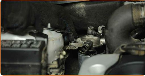
17 Reinigen Sie den Kraftstofffilter. Verwenden Sie Allzweckreinigungsspray.
