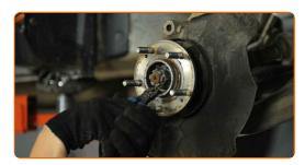
Schrauben Sie die Nabenmutter ab. Verwenden Sie Stecknuss Nr. 32. Verwenden Sie einen Ratschenschlüssel.
