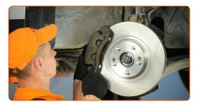
Befestigen Sie die Bremssattelhalterung. Verwenden Sie Ring-Gabelschlüssel Nr. 17. Verwenden Sie Stecknuss Nr. 17. Verwenden Sie einen Drehmomentschlüssel. Ziehen Sie ihn mit 85 Nm Drehmoment fest.
