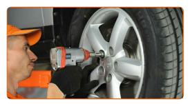
Senken Sie das Auto und ziehen Sie die Radschrauben über Kreuz an. Verwenden Sie eine Schlagnuss für Felgen # 21. Verwenden Sie einen Drehmomentschlüssel. Ziehen Sie ihn mit 108 Nm Drehmoment fest.
