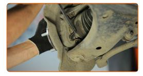
Verbinden Sie das Kugelgelenk mit dem Achsschenkel.
