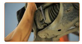
18.2 Verwenden Sie Stecknuss Nr. 14. Verwenden Sie einen Ratschenschlüssel.
