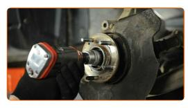
Entfernen Sie die Befestigungsmutter.
