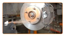
Die Bremsscheibenoberfläche reinigen. Benutzen Sie einen Bremsenreiniger.
