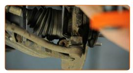
Verwenden Sie Ring-Gabelschlüssel Nr. 14. Verwenden Sie Stecknuss Nr. 14. Verwenden Sie einen Drehmomentschlüssel. Ziehen Sie ihn mit 50 Nm Drehmoment fest.
