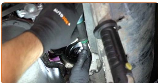
**14** Reinigen Sie den Bereich um die Ablassöffnung der Ölwanne.
