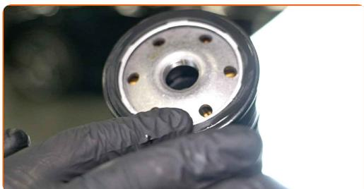
**13** Schrauben Sie den neuen Filter in seinen Platz. Verwenden Sie Steckschlüssel 74-15F. Verwenden Sie einen Drehmomentschlüssel. Ziehen Sie ihn mit 25 Nm Drehmoment fest.
