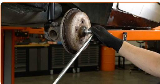
**9** Entfernen Sie die Bremstrommel. Verwenden Sie einen flachen Schraubendreher.
