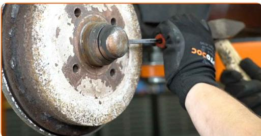
**7** Entfernen Sie den Sicherungssplint, der die Nabenmutter sichert. Benutzen Sie ein Brecheisen.
