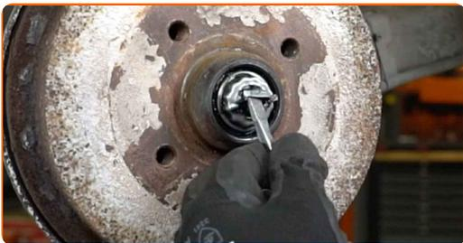
**8** Schrauben Sie die Radnaben-Achsmutter ab. Verwenden Sie Stecknuss Nr. 24. Verwenden Sie ein Windeisen.
