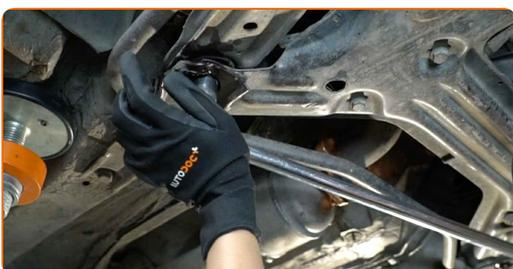
**12** Schrauben Sie die Befestigungen ab, die das Kugelgelenk mit dem Querlenker verbinden. Verwenden Sie Stecknuss Nr. 13. Verwenden Sie einen Ratschenschlüssel.
