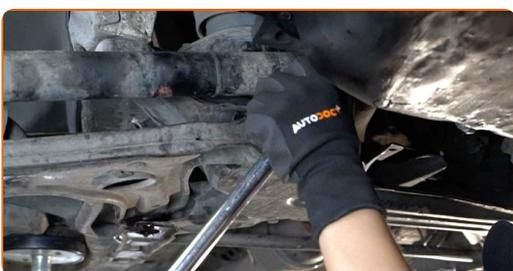
**11** Schrauben Sie das hintere Befestigungselement heraus, das den Querlenker mit dem Hilfsrahmen verbindet. Verwenden Sie Stecknuss Nr. 18. Verwenden Sie ein Windeisen.
