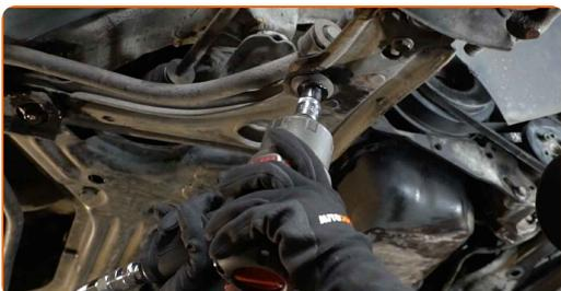
**8** Entfernen Sie die Befestigungsschraube.
