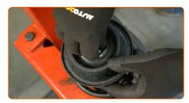
Ziehen Sie die Federbeinkolbenstangenmutter an. Verwenden Sie Ring-Gabelschlüssel Nr. 21. Verwenden Sie eine 14,5 mm Schienenmutterstecknuss. Verwenden Sie einen Drehmomentschlüssel. Ziehen Sie ihn mit 60 Nm Drehmoment fest.
