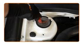
Lösen Sie die obere Befestigung des Domlagers. Verwenden Sie Inbusschlüssel Nr. H6. Verwenden Sie Stecknuss Nr. 21. Verwenden Sie einen Ratschenschlüssel.
