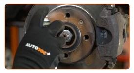
Die Bremsscheibenoberfläche reinigen. Benutzen Sie einen Bremsenreiniger.
