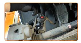
Ziehen Sie den Bremsschlauch Halterung ab.
