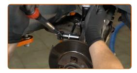
Entfernen Sie den Träger unter dem Arm.
