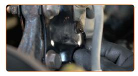
Ziehen Sie die Befestigungsklammer des Bremsschlauchs am Federbein an. Verwenden Sie Stecknuss Nr. 10. Verwenden Sie einen Drehmomentschlüssel. Ziehen Sie ihn mit 13 Nm Drehmoment fest.
