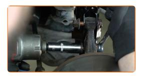
Ziehen Sie die unteren Befestigungen an, die das Federbein mit dem Achsschenkel verbinden. Verwenden Sie Ring-Gabelschlüssel Nr. 18. Verwenden Sie Stecknuss Nr. 18. Verwenden Sie einen Drehmomentschlüssel. Ziehen Sie ihn mit 95 Nm Drehmoment fest.
