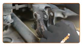
Lösen Sie die obere Befestigung des Domlagers.
