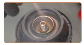
Entfernen Sie das zusammengebaute Federbein.
