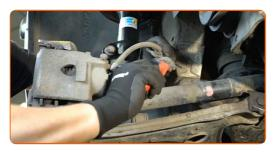
Sichern Sie den Bremsschauch-Befestigungswinkel.
