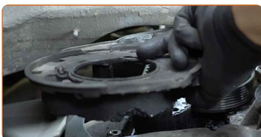
**37** Drehen Sie das Kurbelwellenrad. Verwenden Sie die 12-Kant-Stecknuss Nr. 19. Verwenden Sie einen Ratschenschlüssel.
