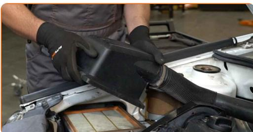
**8** Löse die Befestigungen des Lüftungkanals ab. Verwenden Sie Stecknuss Nr. 7. Verwenden Sie einen Ratschenschlüssel.
