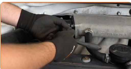
**9** Entferne die Komponenten des Lüftungskanals.
