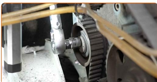
**52** Entfernen Sie die Spannrolle des Zahnriemens.
