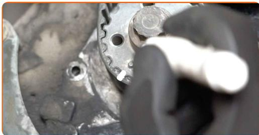
**51** Lockern Sie die Befestigung der Spannrolle des Zahnriemens. Verwenden Sie Stecknuss Nr. 15. Verwenden Sie einen Ratschenschlüssel.
