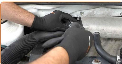
**115** Entfernen Sie den Deckel des Kühlmittelbehälters.
