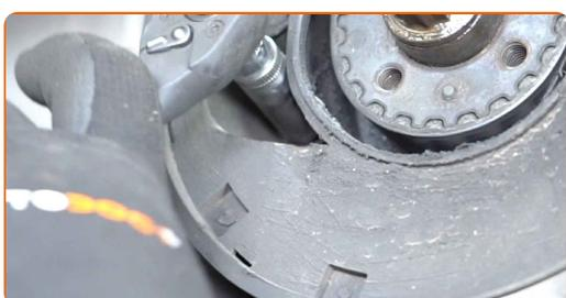
**36** Entfernen Sie die untere Zahnriemenabdeckung.
