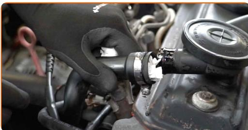
**44** Schrauben Sie die Befestigungselemente des Motorventildeckels ab. Verwenden Sie Stecknuss Nr. 10. Verwenden Sie einen Ratschenschlüssel.
