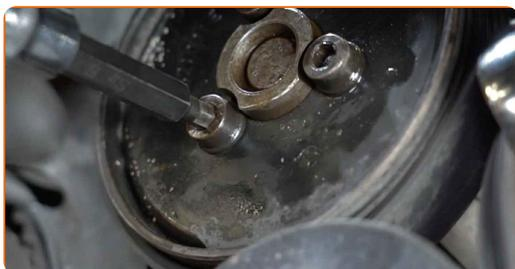
**34** Entfernen Sie die Wasserpumpenriemenscheibe.
