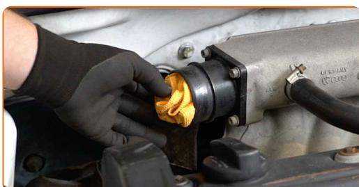
**11** Lösen Sie die Klammern des Luftfiltergehäuses. Entfernen Sie das Luftfiltergehäuse.
