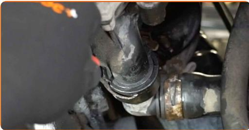
**60** Lösen Sie die untere Kühlmittleitung.
