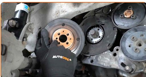
**100** Ziehen Sie das Befestigungselement der Kurbelwellenriemenscheiben fest. Verwenden Sie Inbusschlüssel Nr. H6. Verwenden Sie einen Drehmomentschlüssel. Halten Sie das empfohlene Anzugsdrehmoment ein.
