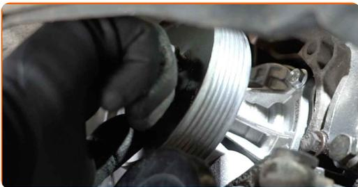
**98** Ziehen Sie das Befestigungselement der Wasserpumpenriemenscheibe fest. Verwenden Sie Inbusschlüssel Nr. H6. Verwenden Sie einen Drehmomentschlüssel. Halten Sie das empfohlene Anzugsdrehmoment ein.
