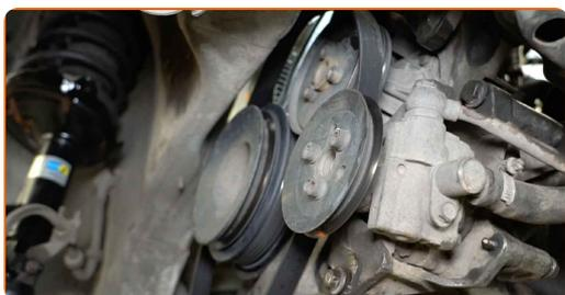
**29** Reinigen Sie das Befestigungselement der Kurbelwellenriemenscheiben. Benutzen Sie eine Drahtbürste. Benutzen Sie WD-40-Spray.
