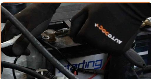
**4** Entfernen Sie die Batterieklemmen.
