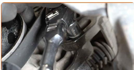
**28** Entfernen Sie den Keilrippenriemen.
