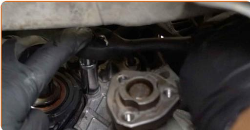
**63** Entfernen Sie die Wasserpumpe. Benutzen Sie ein Brecheisen.
