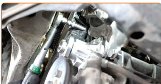
**97** Installieren Sie die Wasserpumpenriemenscheibe.
