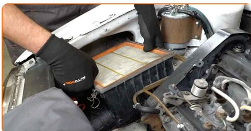
**109** Befestigen Sie die Klammern des Luftfiltergehäuses.
