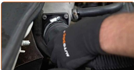
**112** Setzen Sie die Luftfilterabdeckung ein. Befestigen Sie diese.
