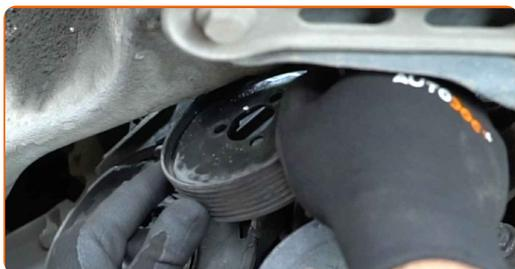
**35** Schrauben Sie die Befestigungen der unteren Zahnriemenabdeckung ab. Verwenden Sie Stecknuss Nr. 10. Verwenden Sie einen Ratschenschlüssel.
