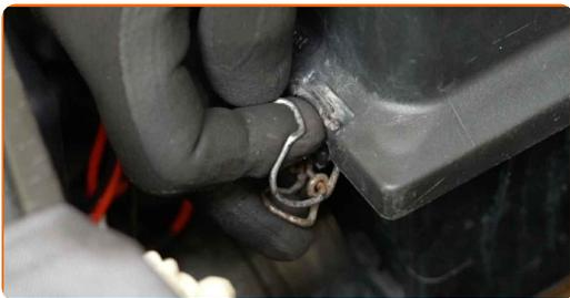
**114** Schraube die Befestigungselemente des Lüftungskanals ein. Verwenden Sie Stecknuss Nr. 7. Verwenden Sie einen Ratschenschlüssel.
