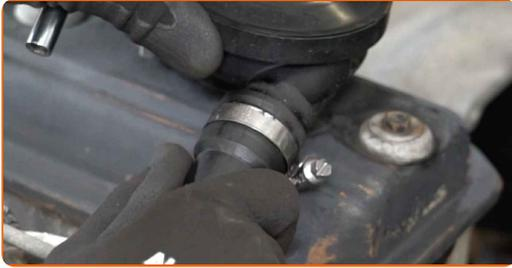
**43** Decken Sie das PCV-Ventilloch mit einem Mikrofasertuch ab, um zu verhindern, dass Schmutz und Fremdkörper in das System gelangen.
