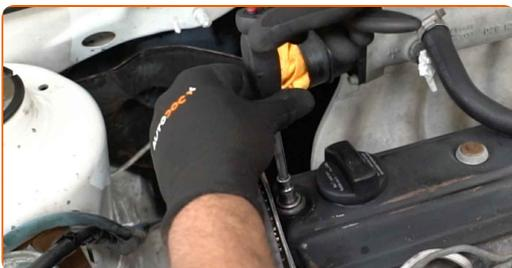
**45** Entfernen Sie den Motorventildeckel.
