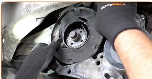
**96** Schrauben Sie die Befestigungen der unteren Zahnriemenabdeckung fest. Verwenden Sie Stecknuss Nr. 10. Verwenden Sie einen Drehmomentschlüssel. Halten Sie das empfohlene Anzugsdrehmoment ein.
