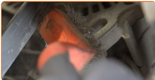
**27** Lockern Sie die Befestigungen der Lichtmaschine. Verwenden Sie Stecknuss Nr. 13. Verwenden Sie Stecknuss Nr. 16. Verwenden Sie einen Ratschenschlüssel.
