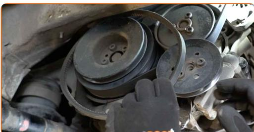
**26** Reinigen Sie die Befestigungen der Lichtmaschine. Benutzen Sie eine Drahtbürste. Benutzen Sie WD-40-Spray.
