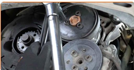
**99** Installieren Sie die Kurbelwellenriemenscheiben entsprechend der Werksmarkierungen.
