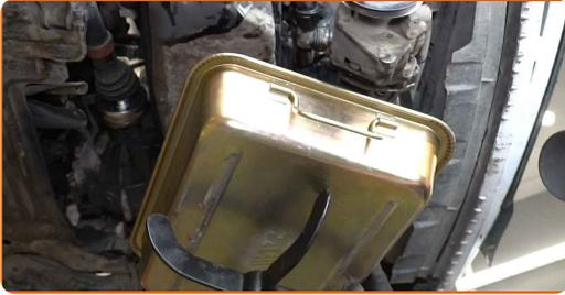
**59** Lösen Sie den Clip des unteren Kühlmittelschlauchs. Benutzen Sie ein Brecheisen.
