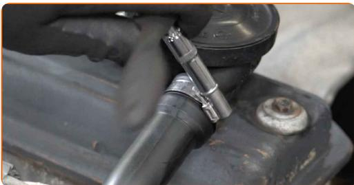
**42** Entfernen Sie den Kurbelgehäuse-Entlüftungsschlauch.
