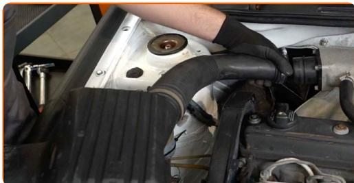
**10** Bedecken Sie die Drosselklappe mit einem Mikrofasertuch, um zu vermeiden, dass Staub und Schmutz in das System gelangen.
