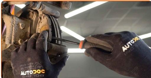
Austausch: Bremsbeläge – INFINITI Q70 (Y51). AUTODOC-Experten empfehlen:
