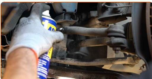
**7** Entfernen Sie den Haltebolzen der Spurstangenköpfe. Benutzen Sie ein Brecheisen. Verwenden Sie eine Rundzange.
