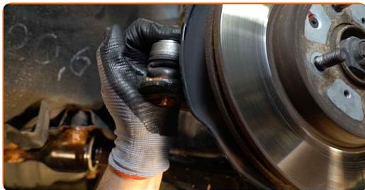
**16** Schrauben Sie die Befestigungsmutter auf, die den Spurstangenkopf mit dem Achsschenkel verbindet. Verwenden Sie Stecknuss Nr. 17. Verwenden Sie einen Ratschenschlüssel.
