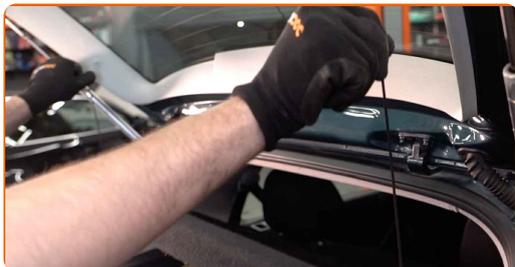
**4** Lösen Sie den Sicherungsring, der die Gasfeder mit dem Kofferraumdeckel verbindet. Verwenden Sie einen flachen Schraubendreher.
