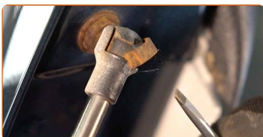
**5** Lösen Sie den Sicherungsring, der die Gasfeder mit der Karosserie verbindet. Verwenden Sie einen flachen Schraubendreher.
