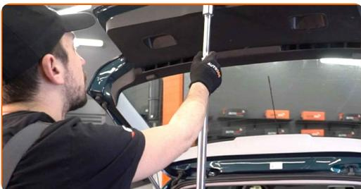
**3** Lösen Sie die Riemen der Hutablage.
