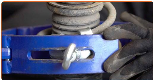
**27** Behandeln Sie die Federbeinstange. Benutzen Sie eine Drahtbürste. Benutzen Sie WD-40-Spray.
