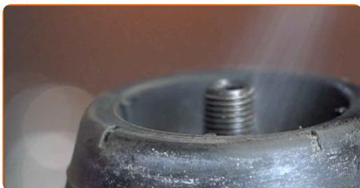
**28** Entfernen Sie die Stangenmutter des Federkolben. Verwenden Sie Stecknuss Nr. 21. Verwenden Sie Inbusschlüssel Nr. H7. Verwenden Sie einen Ratschenschlüssel.
