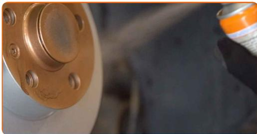
**27** Die Bremsscheibenoberfläche reinigen. Benutzen Sie einen Bremsenreiniger.
