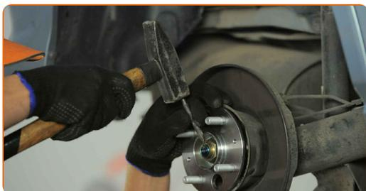
**26** Installieren Sie die Schutzkappe des Nabenlagers. Verwenden Sie einen Gummi-Hammer.
