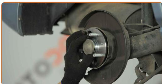
**27** Behandeln Sie die Radnabe an der Kontaktstelle mit der Bremsscheibe. Benutzen Sie ein Kupferschmiermittel.
