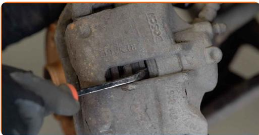
**8** Säubern Sie die Halterung des Bremssattels. Benutzen Sie eine Drahtbürste. Benutzen Sie WD-40-Spray.
