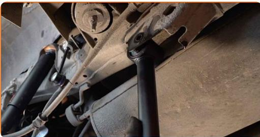
**Austausch: unterer Längslenker der Hinterachse – Toyota Prado J120. Tipp von AUTODOC-Experten:**
