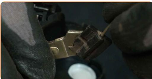
**30** Entfernen Sie die Sicherungsstange des Türschlosses.
