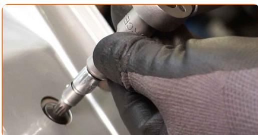
**53** Schrauben Sie die Befestigungen des Türblechs fest. Verwenden Sie Stecknuss Nr. 10. Verwenden Sie einen Drehmomentschlüssel. Ziehen Sie ihn mit 8 Nm Drehmoment fest.
