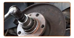
Entfernen Sie die Befestigungsmutter.
