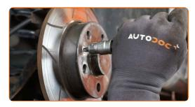
Entfernen Sie die Befestigungsschraube.
