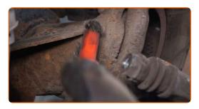
Schrauben Sie die Befestigungen des Bremssattelhalters ab. Verwenden Sie Inbusschlüssel Nr. H8. Verwenden Sie einen Ratschenschlüssel.
