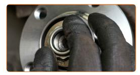
Ziehen Sie die Nabenbefestigung fest. Verwenden Sie die 12-Kant-Stecknuss Nr. 30. Verwenden Sie einen Drehmomentschlüssel. Ziehen Sie ihn mit 175 Nm Drehmoment fest.
