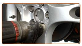
Senken Sie das Auto und ziehen Sie die Radschrauben über Kreuz an. Verwenden Sie eine Schlagnuss für Felgen # 17. Verwenden Sie einen Drehmomentschlüssel. Ziehen Sie ihn mit 120 Nm Drehmoment fest.
