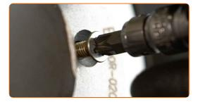
Schrauben Sie die Befestigungen der Bremsscheibe fest. Verwenden Sie einen Kreuzschlitzschraubendreher. Verwenden Sie einen Drehmomentschlüssel. Ziehen Sie ihn mit 4 Nm Drehmoment fest.
