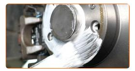
Die Bremsscheibenoberfläche reinigen. Benutzen Sie einen Bremsenreiniger.
