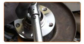
Bauen Sie die Schutzkappe des Nabenlagers ein. Verwenden Sie einen Gummi-Hammer.
