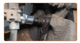
Entfernen Sie die Befestigungsschrauben.
