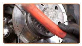
Schrauben Sie die Befestigungen der Bremsscheibe ab. Verwenden Sie einen Schlagschrauber. Benutzen Sie einen Hammer.
