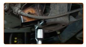
Schrauben Sie die Befestigung der Radnabe ab. Verwenden Sie die 12-Kant-Stecknuss Nr. 30. Verwenden Sie ein Windeisen.
