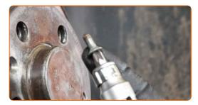
20 Entfernen Sie die Bremsscheibe.
