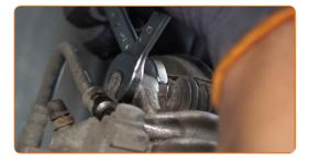
Entfernen Sie die Befestigungsschrauben.
