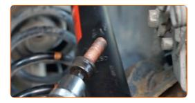
Entfernen Sie den Bremssattelhalter.
