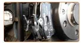
Montieren Sie den Bremssattel.
