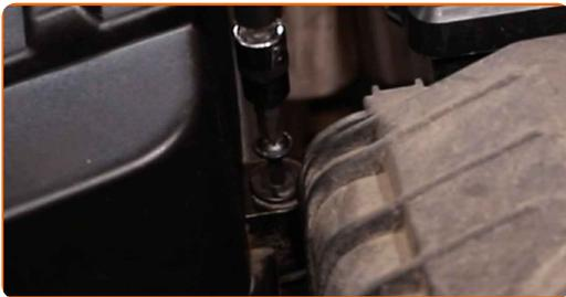
**14** Entfernen Sie die Kotflügel-Abdeckung.
