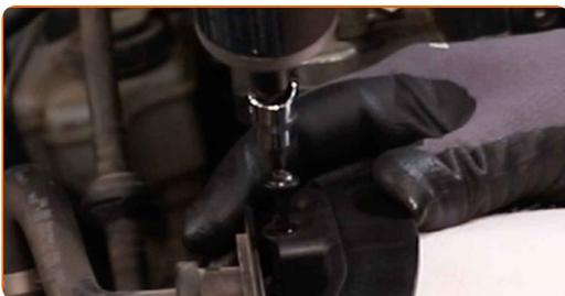
**12** Setzen Sie die Luftfilterabdeckung ein. Befestigen Sie diese.
