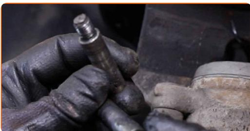
**15** Reinigen Sie die Bremssattel-Führungsstifte. Benutzen Sie einen Bremsenreiniger.
