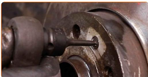
**17** Entfernen Sie die Bremsscheibe.
