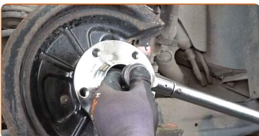
**28** Installieren Sie die Schutzkappe des Nabenlagers. Verwenden Sie einen Gummi-Hammer.
