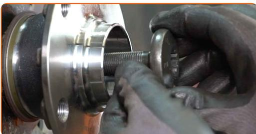
**27** Ziehen Sie die Nabe hindurch. Benutzen Sie den XZN #18. Verwenden Sie einen Drehmomentschlüssel. Ziehen Sie ihn mit 180 Nm Drehmoment fest.
