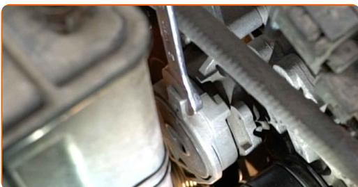
7 Entfernen Sie den Keilrippenriemen.
