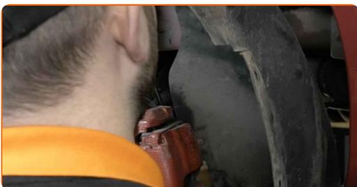
**14** Bringen Sie die Befestigungselemente der Radkastenabdeckung an und ziehen Sie diese an. Verwenden Sie den Torx T25.
