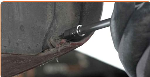
5 Entfernen Sie die Radkastenabdeckung.
