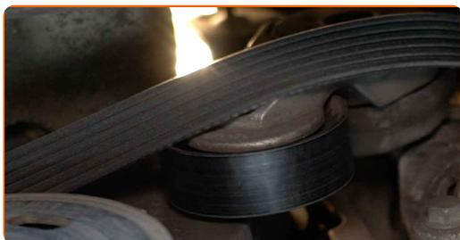
**11** Setzen Sie den Keilrippenriemen auf die Spannrolle auf.
