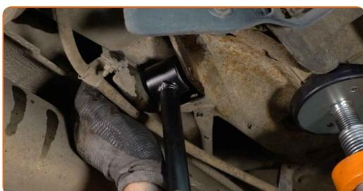
**Austausch: unterer Längslenker der Hinterachse – LEXUS RX (GYL1\_, GGL15, AGL10). Tipp:**
