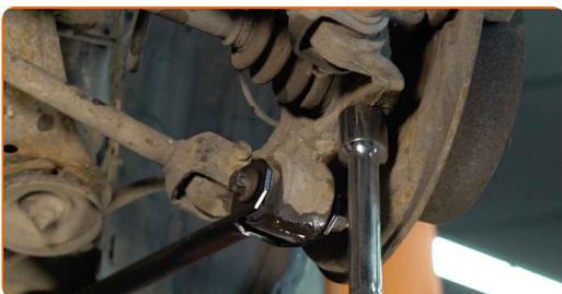
**17** Schrauben Sie die Befestigung, die den Querlenker mit dem hinteren Achsschenkel verbindet, ein. Verwenden Sie Ring-Gabelschlüssel Nr. 18. Verwenden Sie Stecknuss Nr. E18. Verwenden Sie ein Windeisen.
