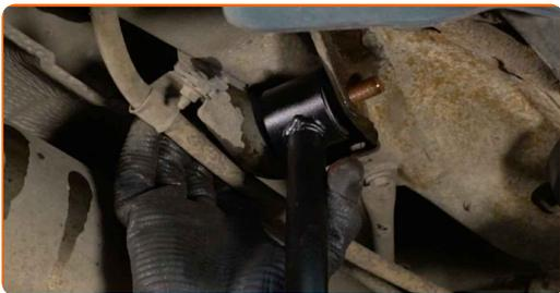
**16** Heben Sie den hydraulischen Getriebeheber um 10–15 cm an.
