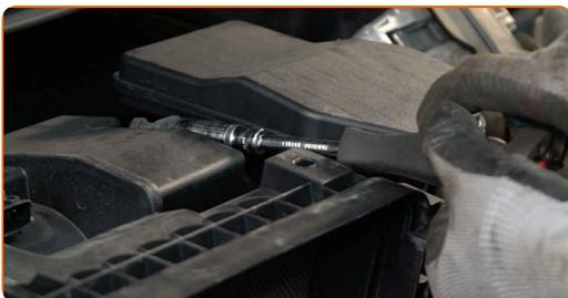
**18** Schrauben Sie die Filtergehäuse-Befestigungsbolzen ab. Verwenden Sie Stecknuss Nr. 10. Verwenden Sie einen Ratschenschlüssel.
