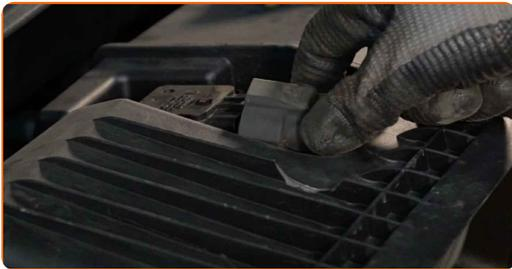
**17** Schrauben Sie die Klemme des Resonators des Ansaugsystems vom Luftfiltergehäuse ab. Verwenden Sie Stecknuss Nr. 10. Verwenden Sie einen Ratschenschlüssel.
