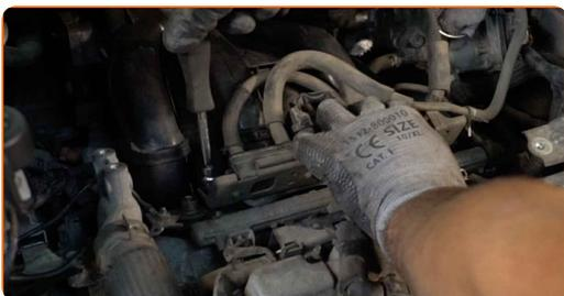
**80** Verbinden Sie den Schlauch des Vakuumsensors.
