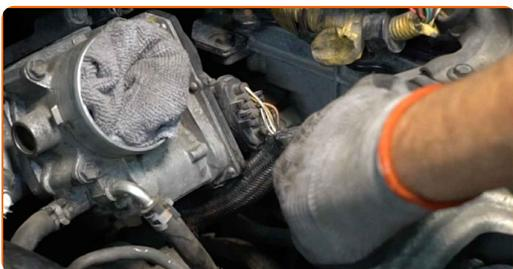
**78** Verbinden Sie den Steckverbinder des Vakuumsensors.
