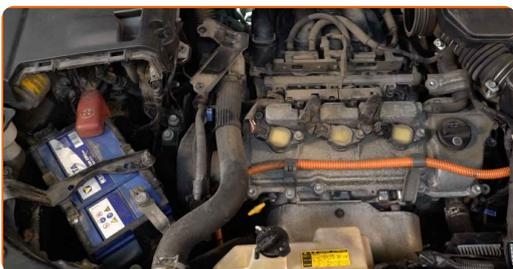
**22** Schrauben Sie die Halterung des Luftfiltergehäuses ab. Verwenden Sie Stecknuss Nr. 12. Verwenden Sie einen Ratschenschlüssel.
