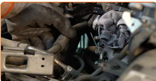
**31** Reinigen Sie die Befestigungen des Ansaugkrümmers. Verwenden Sie Allzweckreinigungsspray.
