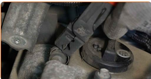
**24** Lösen Sie auf der rechten Seite den Schlauch des PCV-Ventils von der Motorabdeckung.
