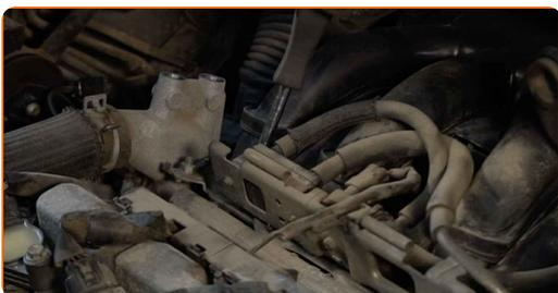
**29** Lösen Sie den Steckverbinder des Vakuumsensors. Verwenden Sie einen flachen Schraubendreher.
