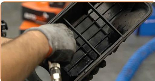
**98** Setzen Sie die Luftfilterabdeckung ein. Befestigen Sie diese.
