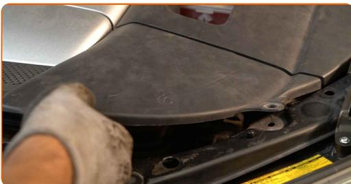
**12** Entfernen Sie die Clips der Motorabdeckung.
