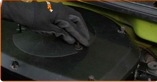
13 Drehen Sie die Befestigungsschrauben der Luftfilter-Abdeckung ein. Verwenden Sie einen Kreuzschlitzschraubendreher. Verwenden Sie Inbusschlüssel Nr. H5. Verwenden Sie einen Ratschenschlüssel.
