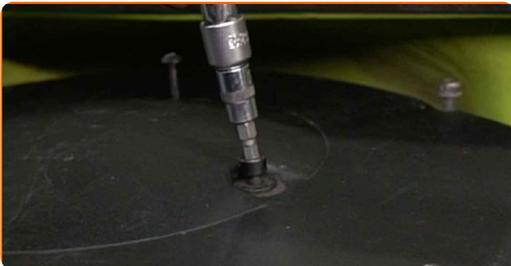
14 Ziehen Sie die Befestigungsschrauben der Luftfilterabdeckung an. Verwenden Sie Inbusschlüssel Nr. H5. Verwenden Sie einen Drehmomentschlüssel. Ziehen Sie ihn mit 8 Nm Drehmoment fest.
