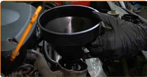
21 Füllen Sie Öl durch den Einfüllstutzen in den Motor. Erforderliche Menge an Öl: 4.4 l.
