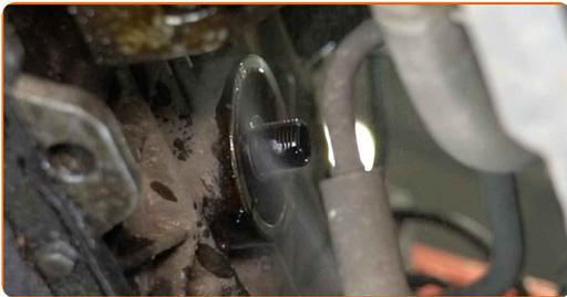
12 Schmieren Sie die Gummidichtung des neuen Filters mit einer kleinen Menge frischen Öls.
