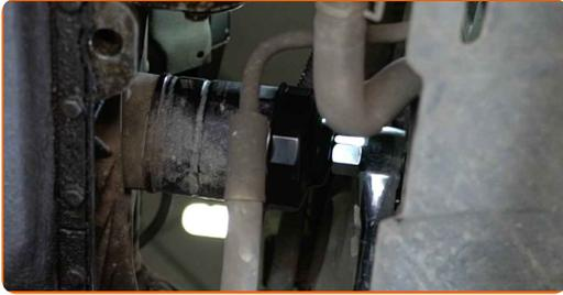
11 Reinigen Sie die Ölfilteraufnahme. Verwenden Sie Allzweckreinigungsspray.
