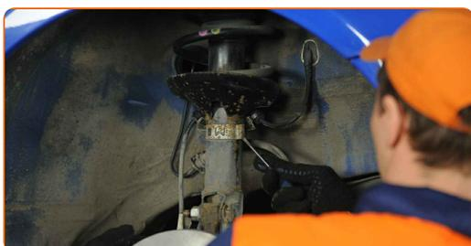
**7** Trennen Sie die ABS Sensorverdrahtung.
