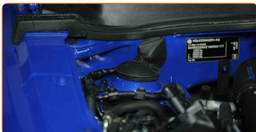
**31** Entfernen Sie die Kotflügel-Abdeckung.
