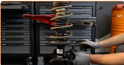
**27** Installieren Sie das Federbein am Radlauf.
