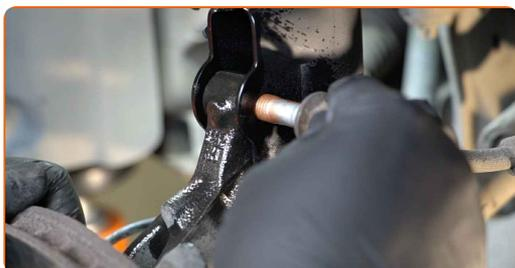
**35** Ziehen Sie die unteren Befestigungen an, die das Federbein mit dem Achsschenkel verbinden. Verwenden Sie Ring-Gabelschlüssel Nr. 18. Verwenden Sie Stecknuss Nr. 18. Verwenden Sie einen Drehmomentschlüssel. Ziehen Sie ihn mit 40 Nm Drehmoment fest.+90°
