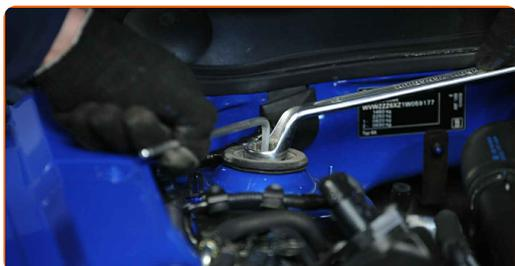
**30** Installieren Sie die Schutzkappe des Stoßdämpfers.
