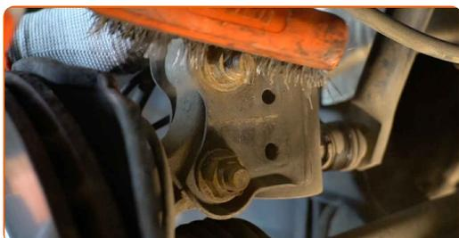
**9** Schrauben Sie das untere Befestigungselement ab, das das Federbein mit dem Achsschenkel verbindet. Verwenden Sie Ring-Gabelschlüssel Nr. 18. Verwenden Sie Stecknuss Nr. 18. Verwenden Sie einen Ratschenschlüssel.
